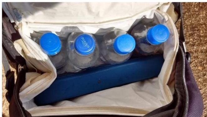
Figura 5 - Frascos de coleta de polietileno armazenados em bolsa térmica sob refrigeração
