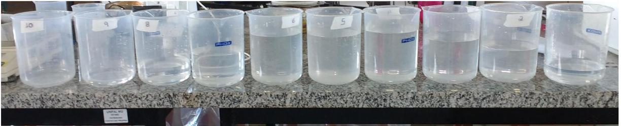
Figura A. 6: Amostras coletadas durante os ensaios de transporte de material em suspensão (areia fina).
