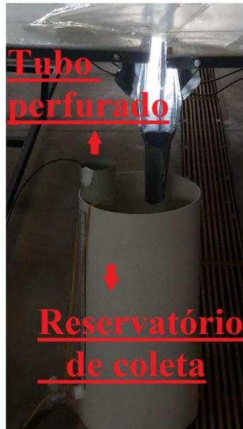
Figura A. 5: Reservatório de coleta de escoamento superficial e tudo com diâmetro reduzido e perfurado para posicionamento do sensor de nível.
