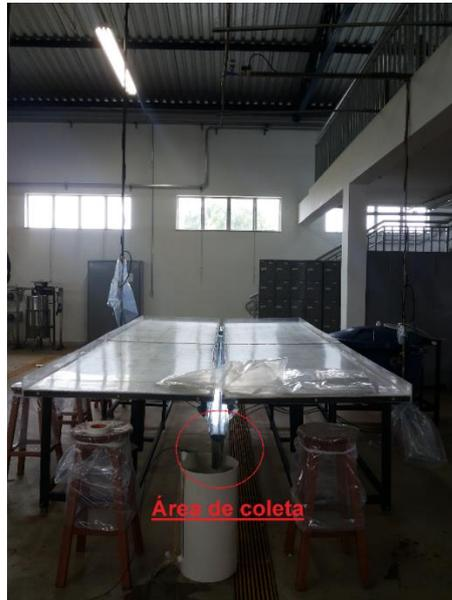
Figura 11 – Configuração experimental utilizada em laboratório para a coleta do deflúvio e da massas de material em suspensão e dissolvido transportas pela superfície.
