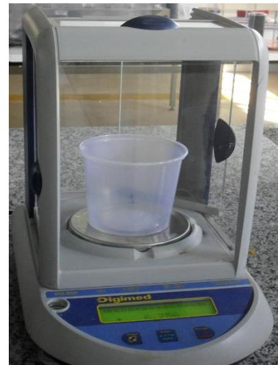
Figura A. 4: Pesagem do recipiente plástico utilizado na captação da lâmina precipitada durante os ensaios de calibração do simulador de chuvas.
