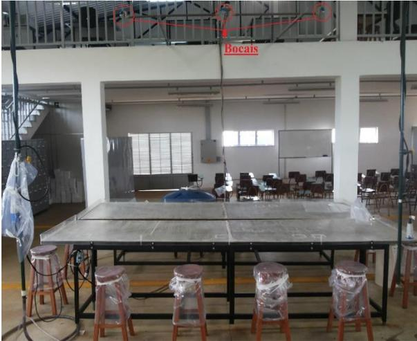
Figura A. 1: Simulador de chuvas sobre superfície impermeável composto por três bocais do tipo cone completo.
