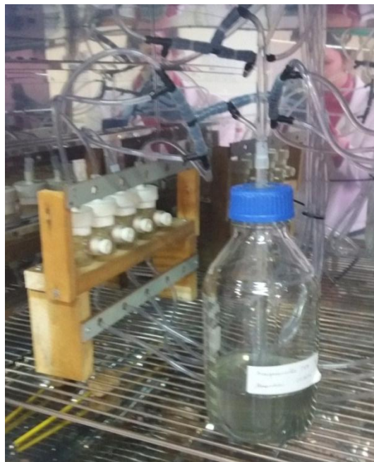
Figura 4.7 - Foto dos reatores diferenciais, em operação, instalados na estufa para controlar a temperatura.
