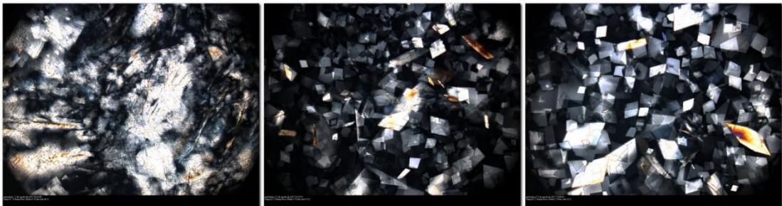
Figura 22 - Fases cristalinas do ácido esteárico em acetato de etila/isopropanol 40/60 em três diferentes rampas de resfriamento a 5 °C/min a uma mesma temperatura.
