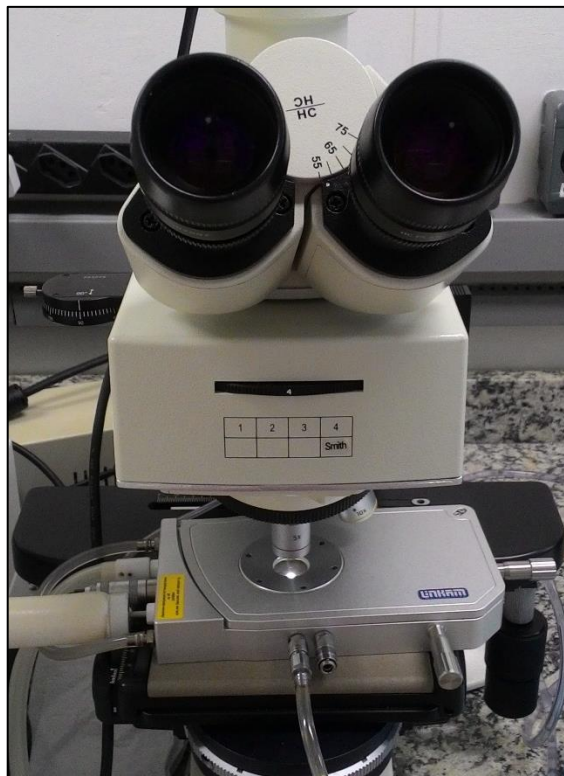
Figura 10 - Microscópio de luz polarizada equipado com dispositivo hot-stage . Imagem do equipamento da Faculdade de Engenharia Química da Unicamp, Campinas.
