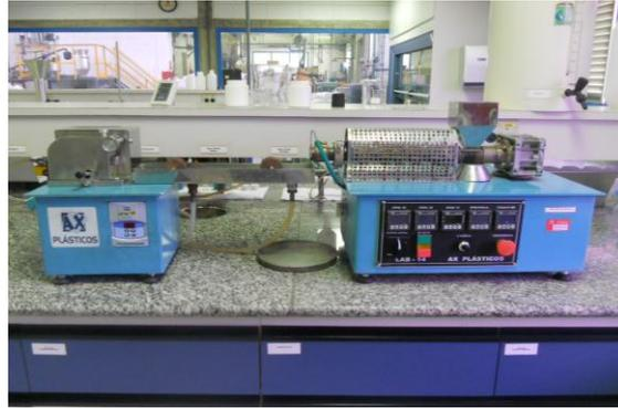
Figura 17 - Mini extrusora utilizada para a produção de concentrado.
