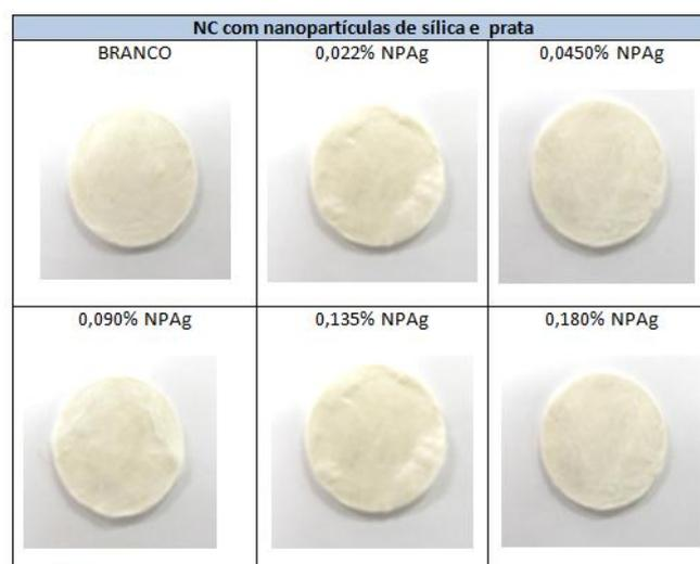
Figura 35 - Corpos de prova produzidos com nanopartículas de prata e sílica variando de concentração no compósito
