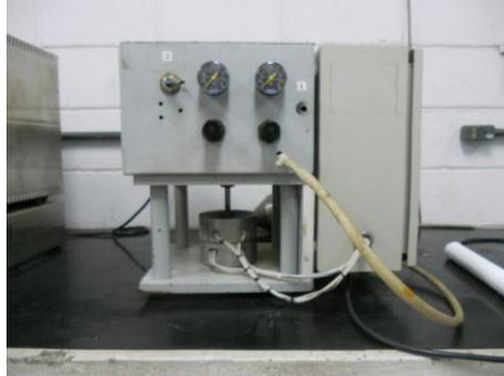
Figura 20 - Prensa utilizada para confecção dos corpos de prova
