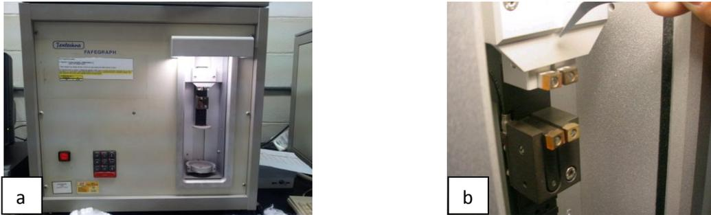
Figura 24 - Equipamento Fafegraph para medidas das propriedades mecânicas da Fibra
