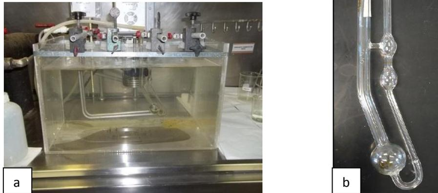
Figura 22 - Aparato para medição de viscosidade intrínseca
