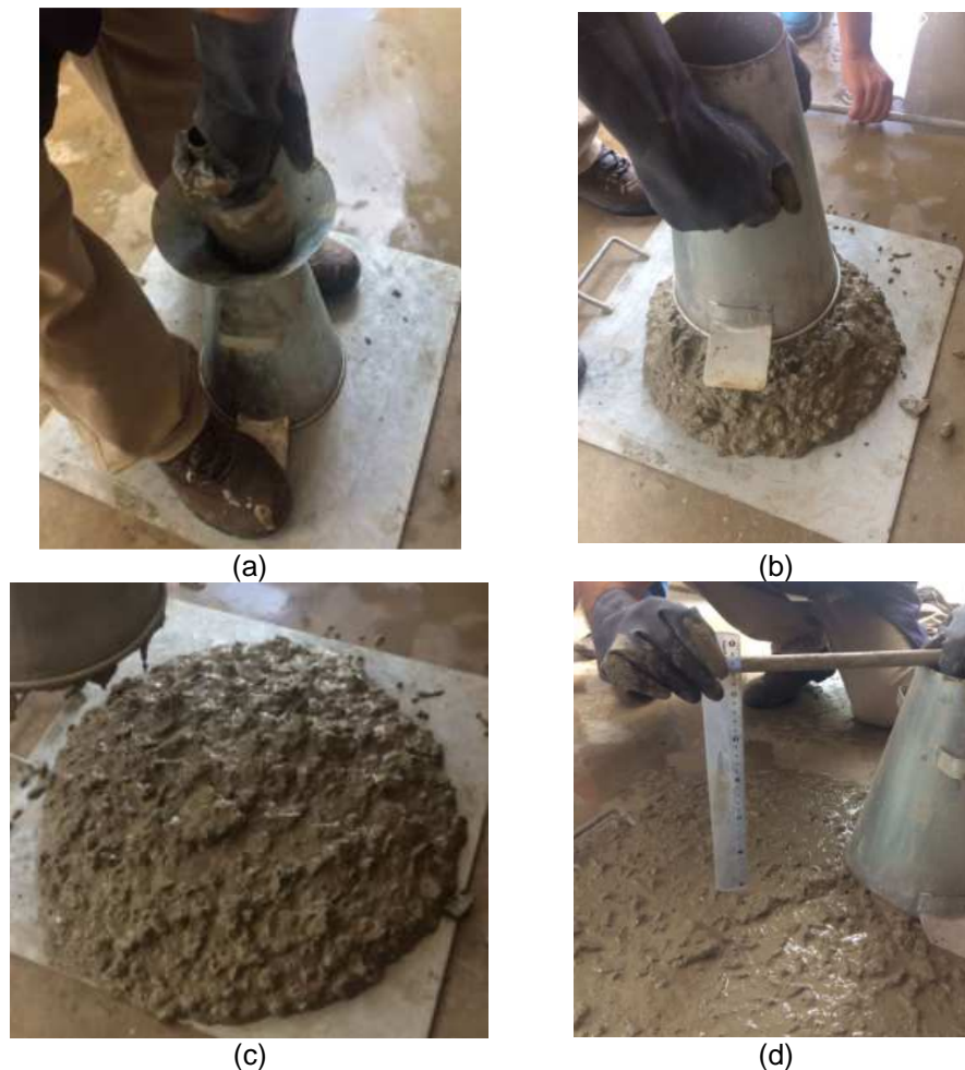
Figura 6 - Sequência do slump teste: (a) colocação do concreto no tronco de cone; (b) retirada do tronco de cone; (c) espalhamento do concreto sobre a placa metálica da base; (d) medida do abatimento.
