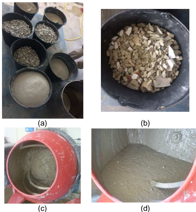
Figura 5 - Preparação do concreto: (a) Matérias-primas utilizadas na fabricação do concreto; (b) Detalhe do scrap cerâmico; (c) Betoneira; (d) Detalhe da massa de concreto
