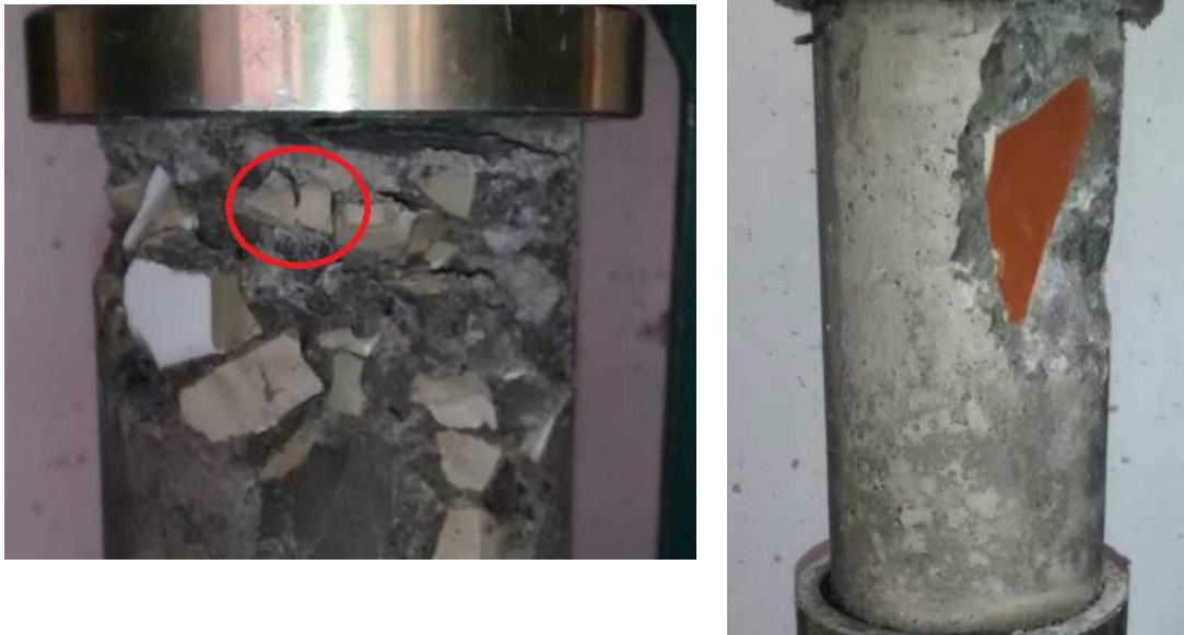
Figura 18 - Corpos de prova: (a) Detalhe da ruptura do scrap cerâmico no corpo de prova de concreto CSC-II; (b) Fragmento de scrap cerâmico no corpo de prova de concreto CSC-I com 14 dias de cura.
