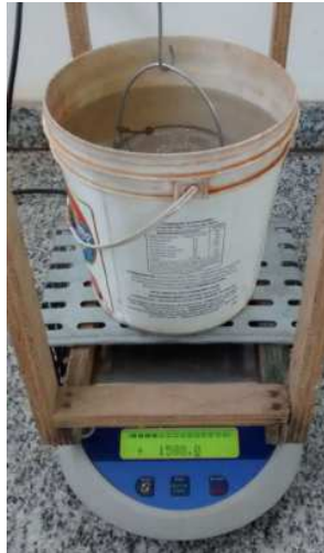
Figura 4 - Aparato para determinação da massa da amostra submersa em água.
