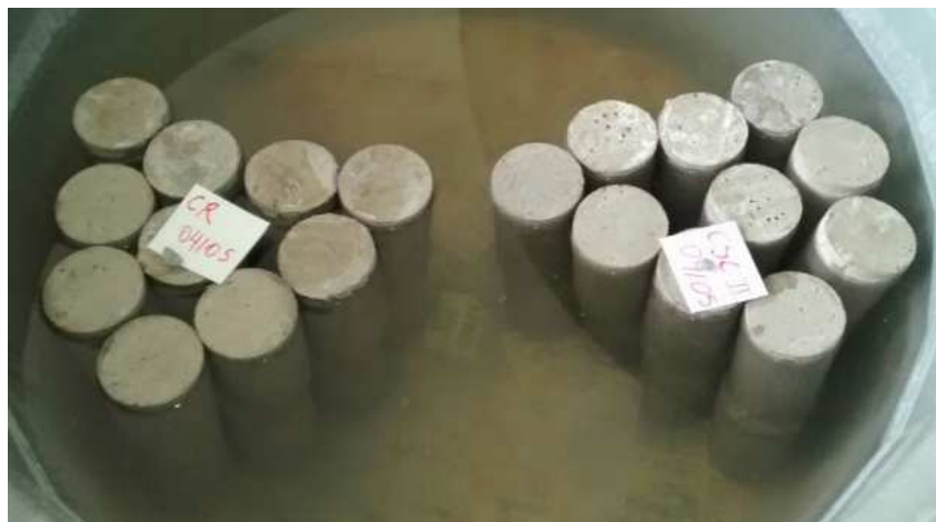
Figura 9 - Corpos de prova de concreto submersos em água para cura.
