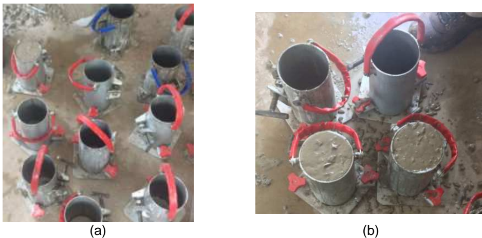
Figura 7 - Fabricação dos corpos de prova: (a) Moldes utilizados para fabricação dos corpos de prova de compressão; (b) Corpos de prova moldados.
