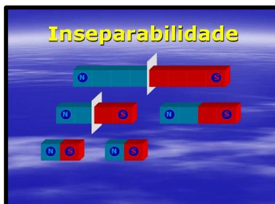
Figura 24 - Representação da inseparabilidade dos polos magnéticos.
