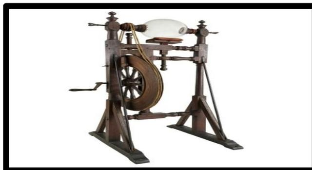
Figura 4 - Máquina eletrostática de Franklin.
