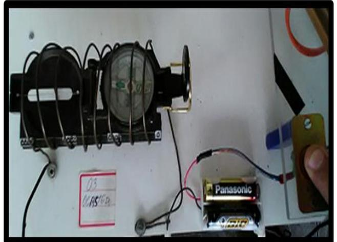
Figura 45 - Norte da bússola apontando para o norte do solenoide em concordância com a Figura 44.
