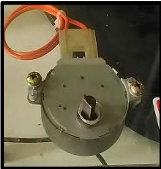
Figura 55 - Motor de micro-ondas.
