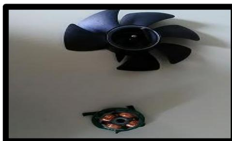
Figura 61- Cooler de computador desmontado.
