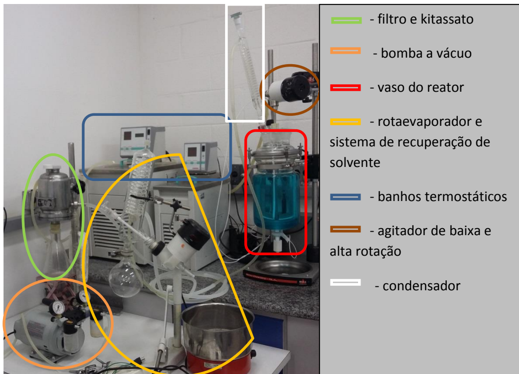
Figura 4.1 - Sistema usado no fracionamento e interesterificação de óleos e gorduras e recuperação do solvente.
