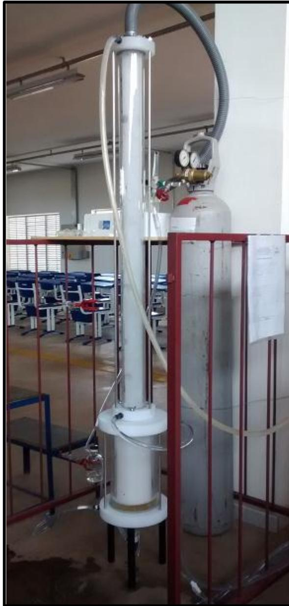
Figura 4 - Coluna de bolhas e espuma
