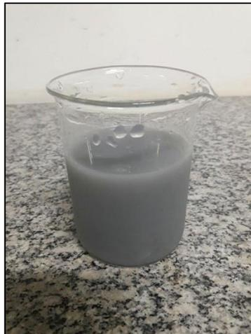
**Figura 6-** Água residuária da lavagem de garrafas PET destinadas à reciclagem.
