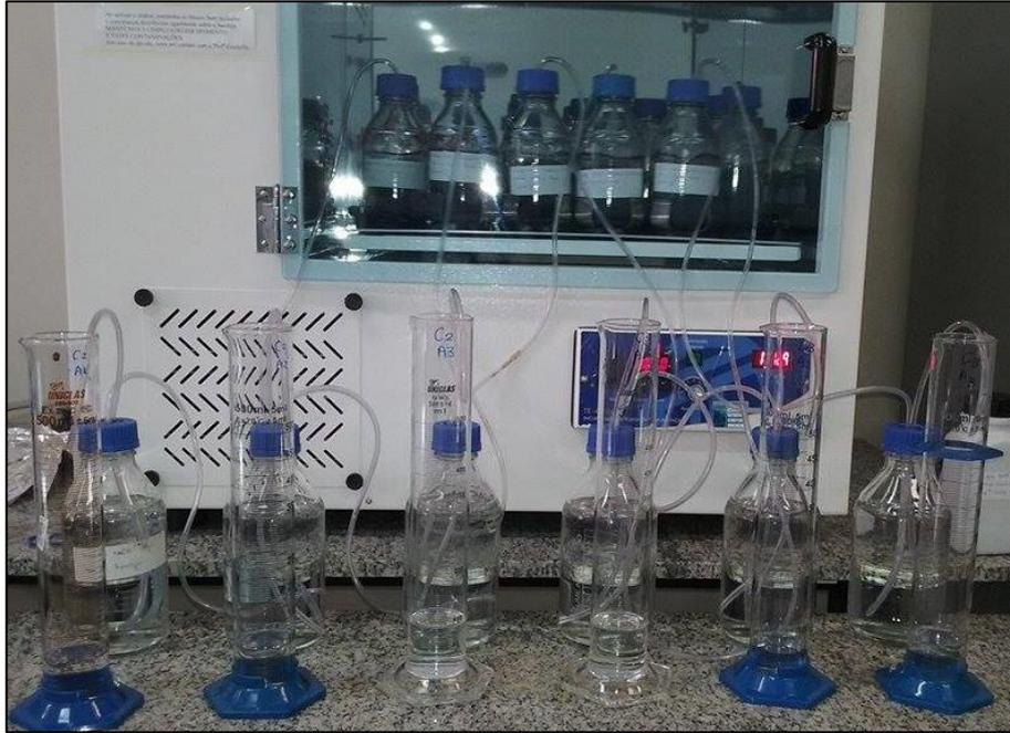
**Figura 7-** Esquema utilizado no ensaio de atividade metanogênica específica com lavagem de biogás.
