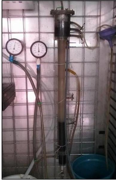
**Figura 16-** RALF conectado aos manômetros para realização do ensaio de mínima fluidificação.
