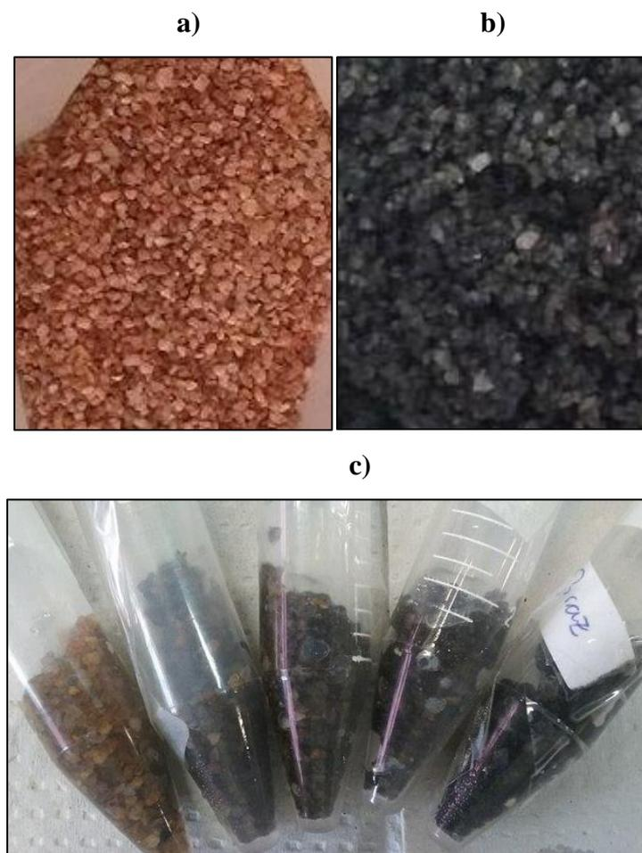
**Figura 27-** Evolução do crescimento da biomassa no suporte. a) Areia antes da inoculação, b) Areia ao final da operação e c) Mudança na coloração da areia devido ao crescimento da biomassa ao longo da operação do reator. Fonte: Do autor.
