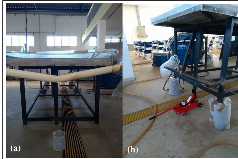
Figura 6 - Foto dos instrumentos utilizados. (a) Reservatório de coleta do material em suspensão e quantificação do escoamento superficial. (b) Elevador hidráulico para alteração da declividade.
