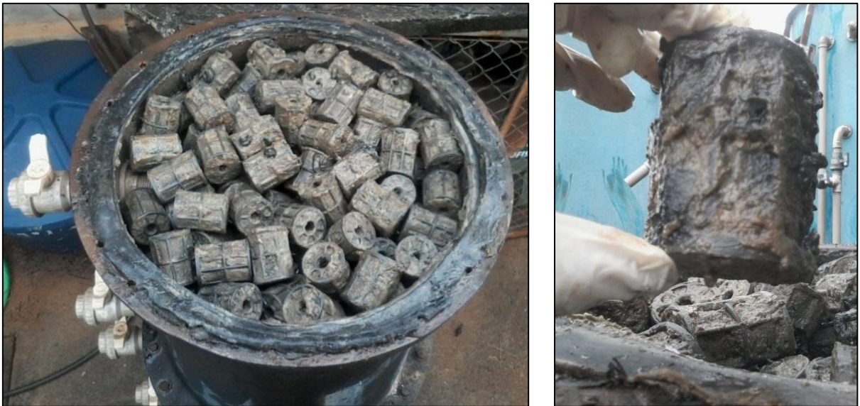
Figura 8 - Biomassa immobilizada em Biobob ® dentro do reator.
