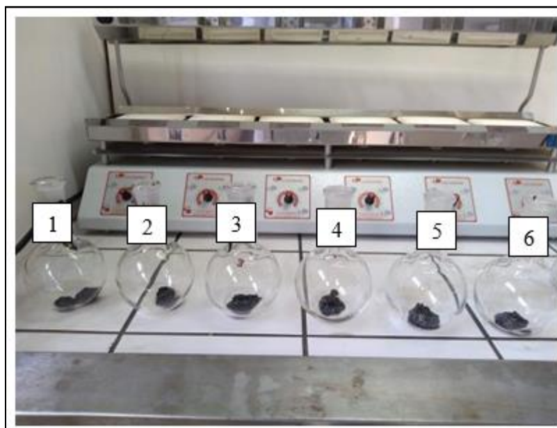
Figura 10 - 30g de amostra sendo distribuída em 6 partes iguais em balão de fundo chato
