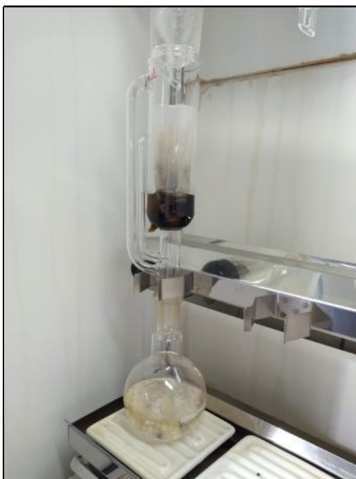
Figura 12 - Ilustração do processo de extração de asfaleno utilizando o Soxhlet
