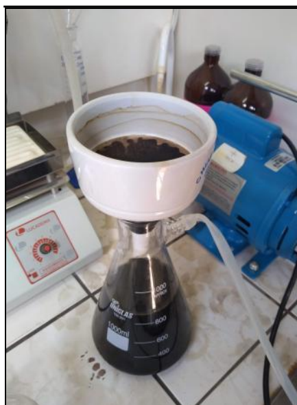
Figura 11 - Foto ilustrando o processo de filtração a vácuo
