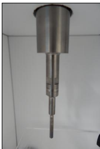
Figura 8 - Sonotrodo H3 para amostras de até 200mL
