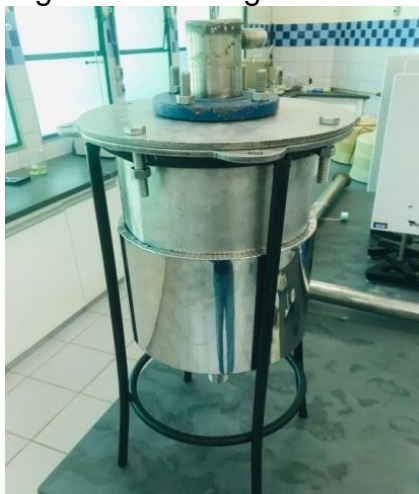
Figura 12 - Biodigestor com resistência do tipo coleira
