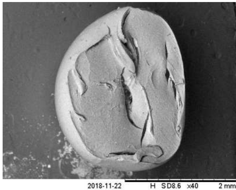
Figura 5.27 - Micrografia MEV da superfície da esfera de alg. B.V. (4,0% m/m) sem a carga de biomassa reticulada, utilizando como íon reticulante \text{Ca}^{2+} na concentração de 0,2 \text{ mol.L}^{-1} e bico de gotejamento de 0,7 mm (aumento de 100 vezes).
