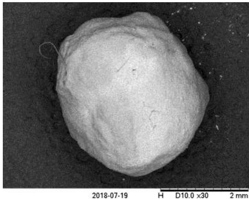
Figura 5.29 - Micrografia MEV de uma esfera de alg. M.V. (1,2% m/m) contendo a biomassa reticulada, utilizando como íon reticulante \text{Ca}^{2+} na concentração de 0,5 \text{ mol.L}^{-1} e bico de gotejamento de 0,7 \text{ mm} (aumento de 30 vezes). Fonte: Autora.
