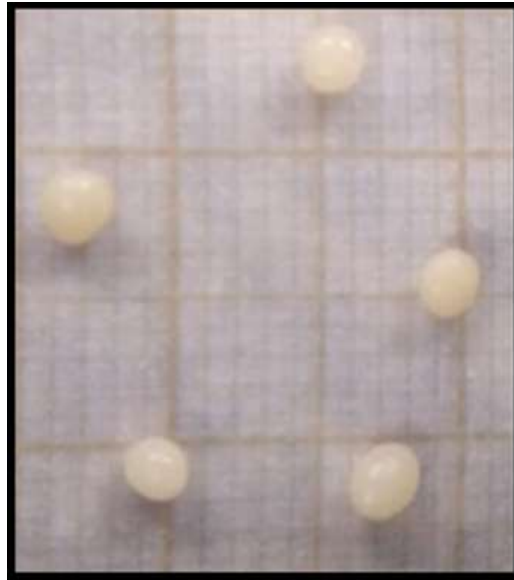
Figura 5.9 - Fotografia de esferas de alg. B.V. (4,0% m/m) contendo a biomassa reticulada com glutaraldeído, reticuladas com 0,2 mol.L -1 de CaCl 2 .2H 2 O.
