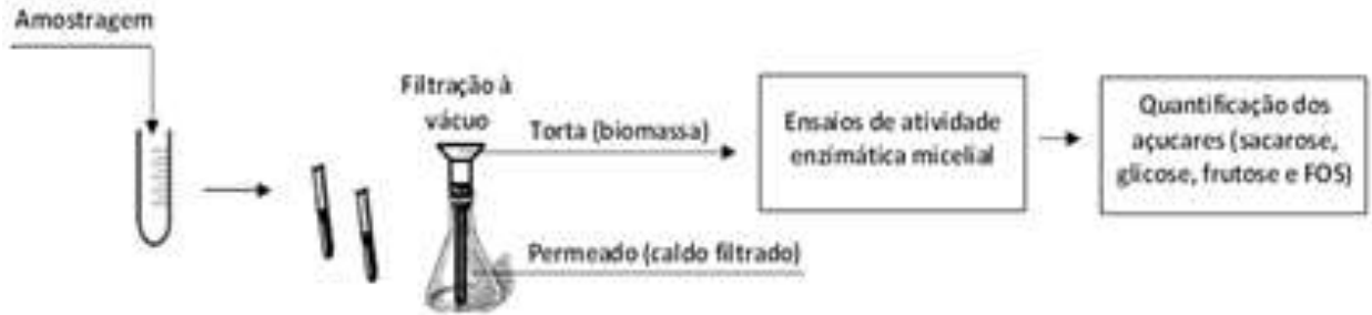
Figura 4.4 - Esquema geral de amostragem. Fonte: Autora.
