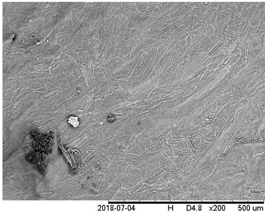
Figura 5.22 - Micrografia MEV de uma esfera de alg. B.V. (4,0% m/m) contendo a biomassa reticulada, utilizando como íon reticulante \text{Ca}^{2+} na concentração de 0,2 \text{ mol.L}^{-1} e bico de gotejamento de 0,7 mm (aumento de 50 vezes). Fonte: Autora.
