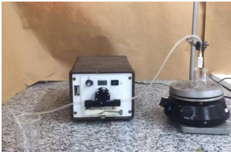
Figura 4.2 - Sistema de gotejamento da solução de alginato contendo a biomassa previamente reticulada com glutaraldeído sobre soluções de cloreto de cálcio ou de bário. Fonte: Autora.
