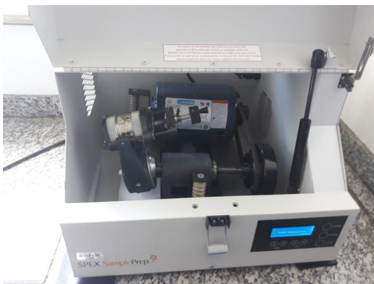
Figura 13 – Moinho SPEX do laboratório de preparo de amostras
