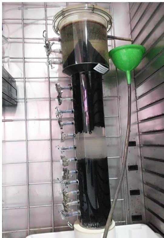
Figura 7 - Suspensão da biomassa no reator referente às cavitações geradas em seu interior.
