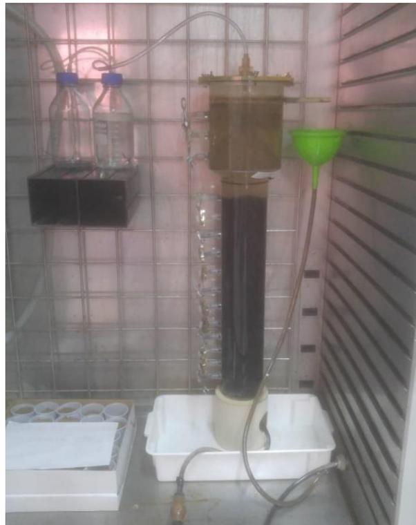
Figura 4 - Reator UASB em operação
