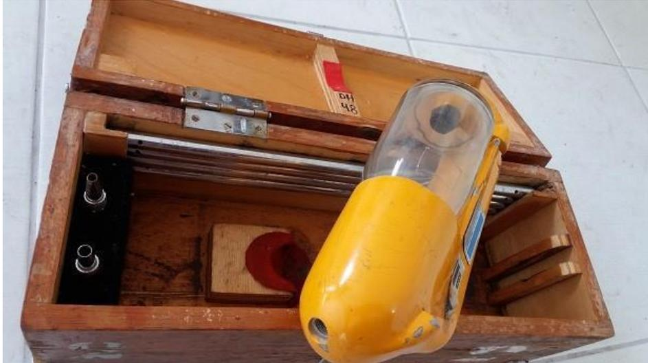
Figura 8 - Amostrador de sedimentos modelo US-DH-48 ou AMS-1.
