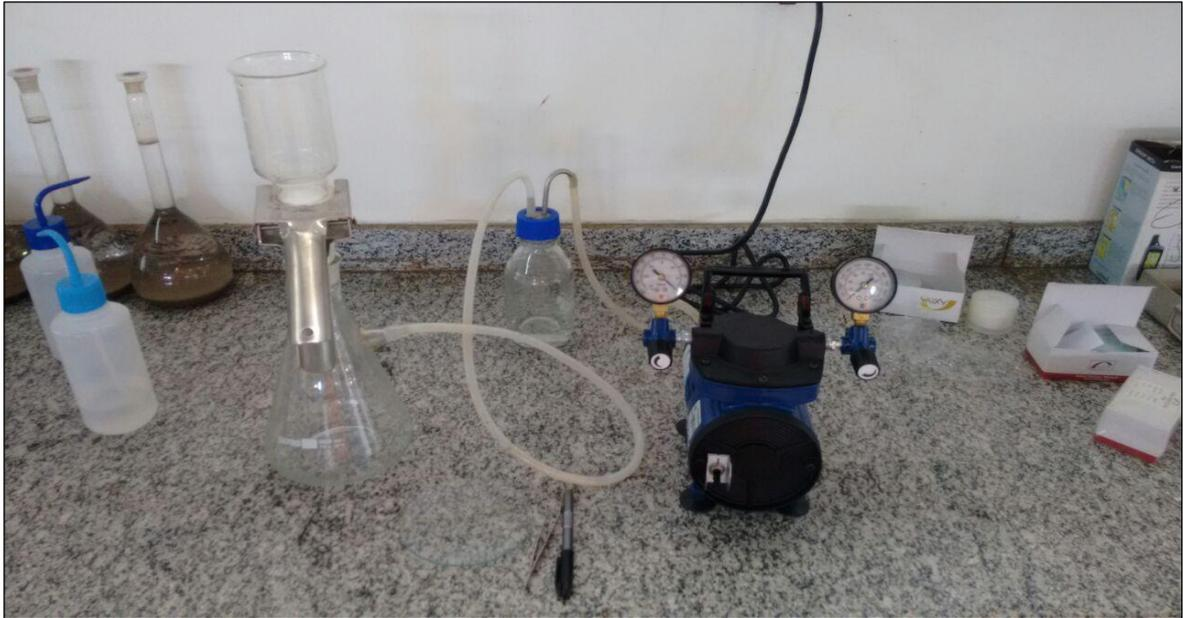
Figura 12 - Aparato de filtragem das amostras de hidrossedimento.
