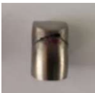
Figura 18 - Imagem típica de prova da liga Ti-Zr-Si-B fraturados após ensaio de compressão.
