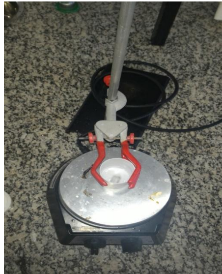
Figura 5 - Foto da síntese do polímero MSH, contendo no béquer: PDMS, 3-MPTMS, tetrahidrofurano e 3% de catalisador em relação à massa de PDMS.
