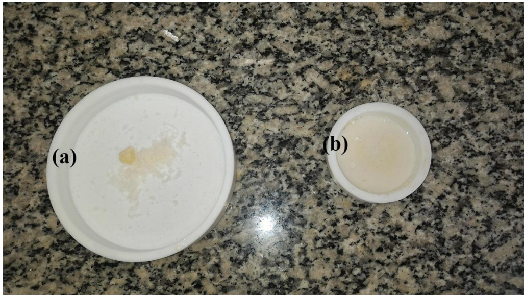
Figura 12 - Apresentação dos métodos de fixação das AgNPs no material MSH. Em (a), o experimento por procedimento adsortivo. Em (b), o filme elastomérico resultante da adição de AgNPs durante o processo reacional
