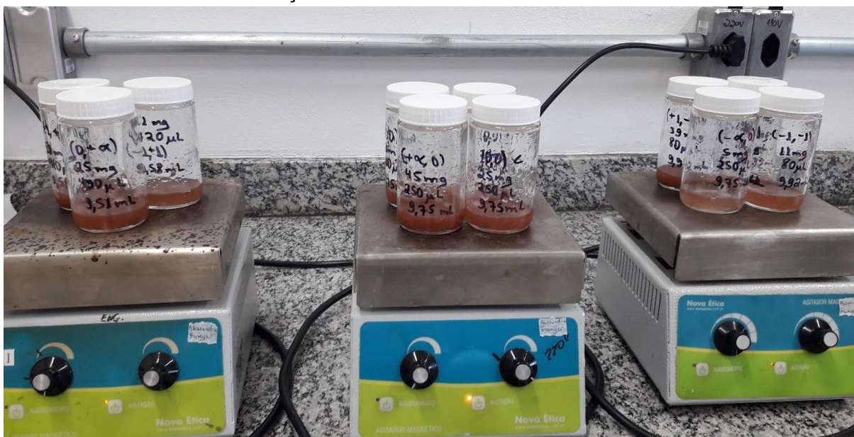
Figura 18 - Amostras sendo agitadas durante a adsorção e degradação da fluoxetina com resíduos de mineração testados como catalisadores
