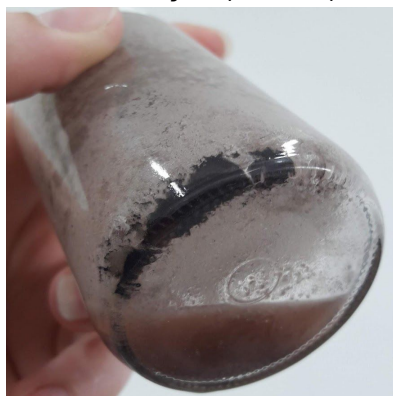
Figura 34 - Separação do ferro após teste com pontos extremos, utilizando o rejeito de mineração (Fe-Res) como catalisador na degradação da FLX com \text{H}_2\text{O}_2
