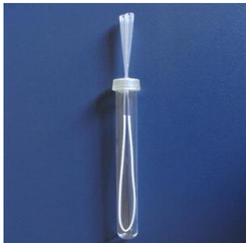
Figura 12 - Aparato de extração por LPME para agitação simultânea (Magalhães e Bonato, 2009).
