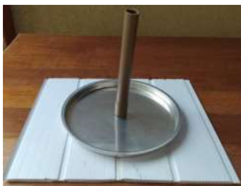
Figura 18 - Eletróforo de Volta Fonte: o autor.
