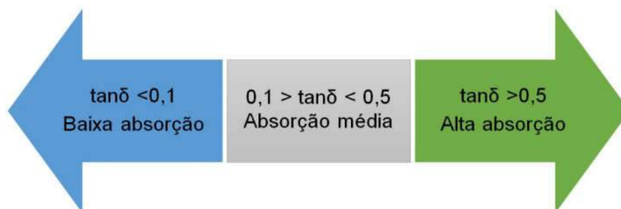
Figura 8 - Classificação dos solventes em função da capacidade de absorção para conversão de das micro-ondas em calor.
