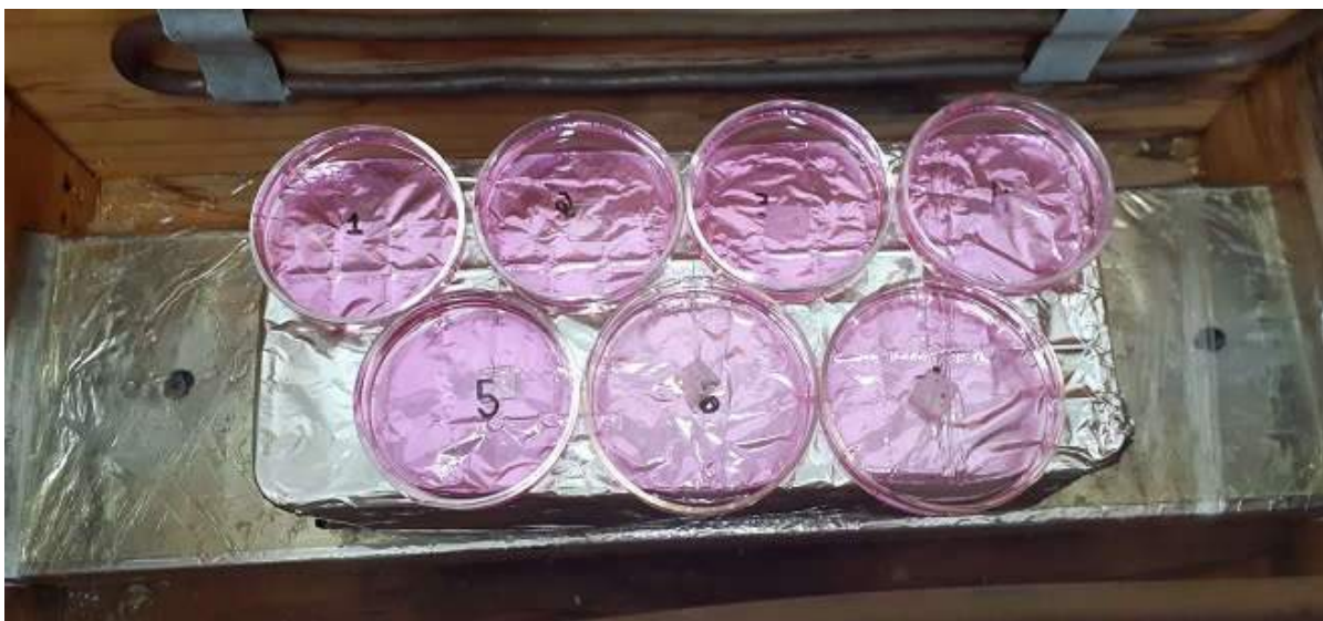
Figura 17 - Ensaio de fotocatalise em reator
