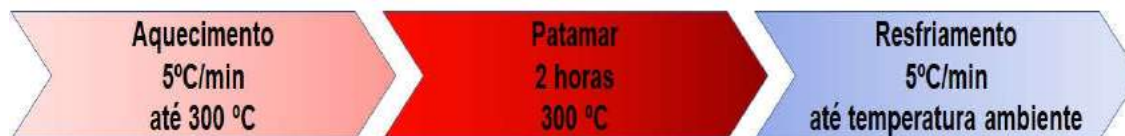
Figura 18 - Procedimento para tratamento de filme para reuso
