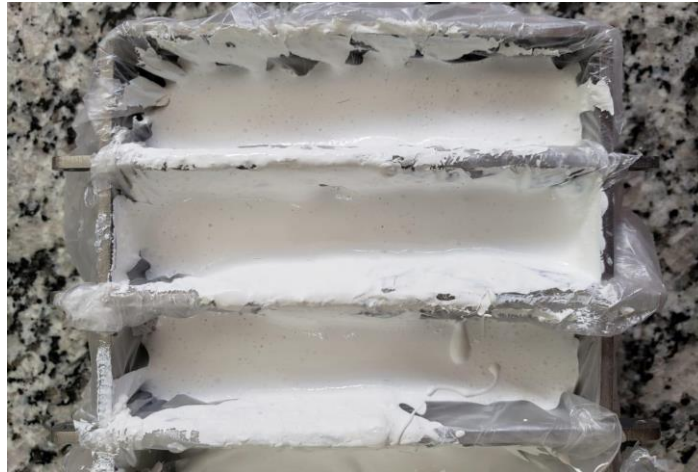
Figura 15 - Barbotinas após serem vertidas no molde de aço encapado com plástico
