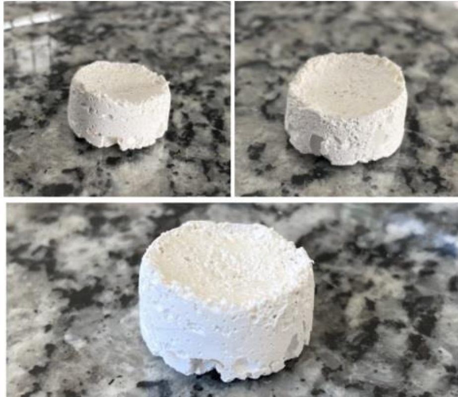
Figura 20 - Peças de ZnO obtidas via gelatinização a frio após sinterização convencional após 24 sob resfriamento. Nota-se que, apesar de muito uniforme, alguns defeitos e falhas ainda estão presentes na superfície das peças
