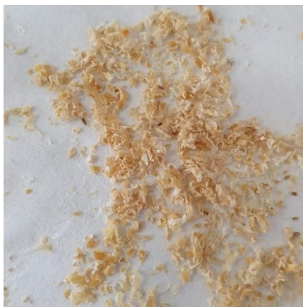
Figura 6 – Suporte com enzima após a secagem em estufa
