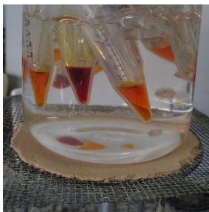
Figura 7 - Amostras com DNS em banho-maria a 100 °C
