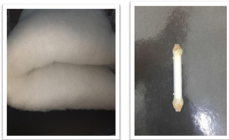
Figura 3- Lã de Pet e a mini coluna de lã de pet respectivamente
