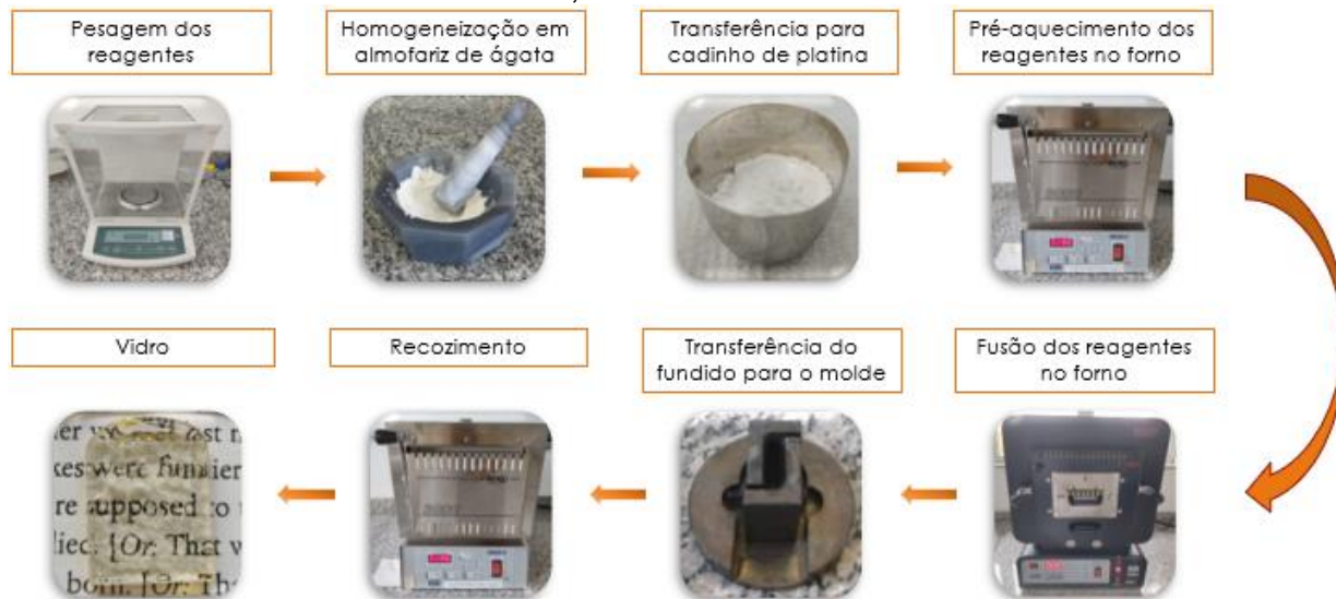
Figura 8 - Esquema ilustrativo das etapas de preparação das amostras vítreas para os sistemas: \text{NaPO}_3\text{-Nb}_2\text{O}_5 , \text{KPO}_3\text{-Nb}_2\text{O}_5 e \text{NaPO}_3\text{-KPO}_3\text{-Nb}_2\text{O}_5
