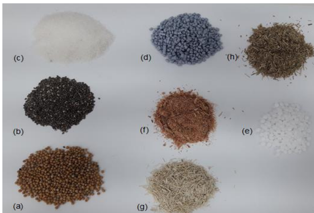
Figura 13 - Materiais avaliados como fase de sacrifício no Processamento C.
