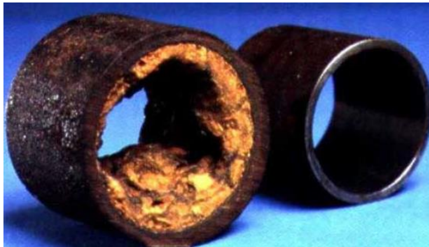
Figura 5 – Tubo de caldeira aquatubular com incrustações por óxidos de ferro
