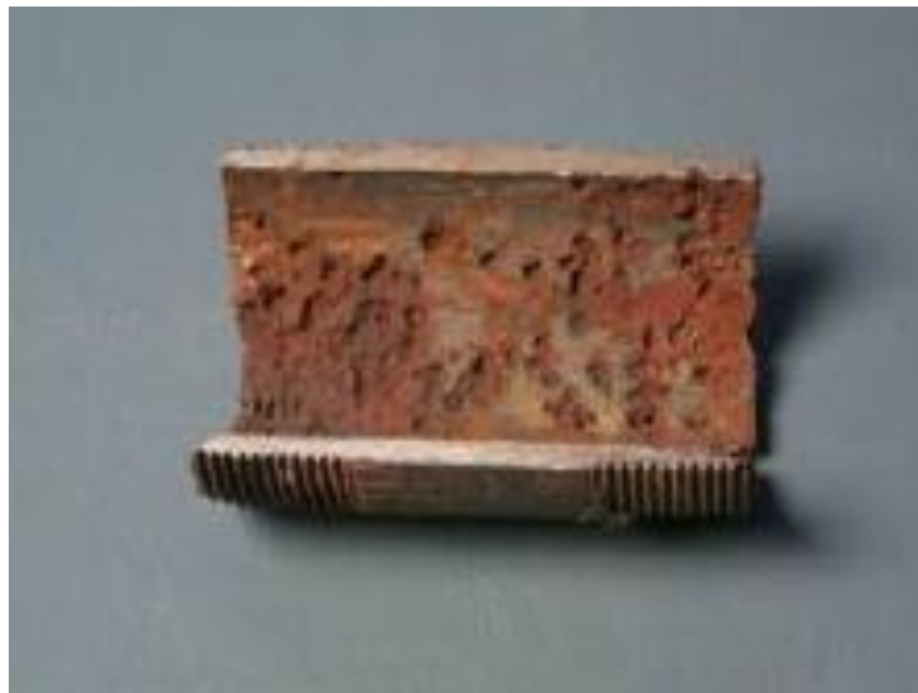
Figura 8 – Corrosão por oxigênio dissolvido
