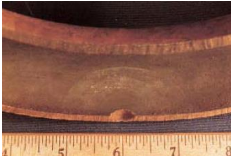
Figura 9 – Corrosão por oxigênio em tubo de superaquecedor
