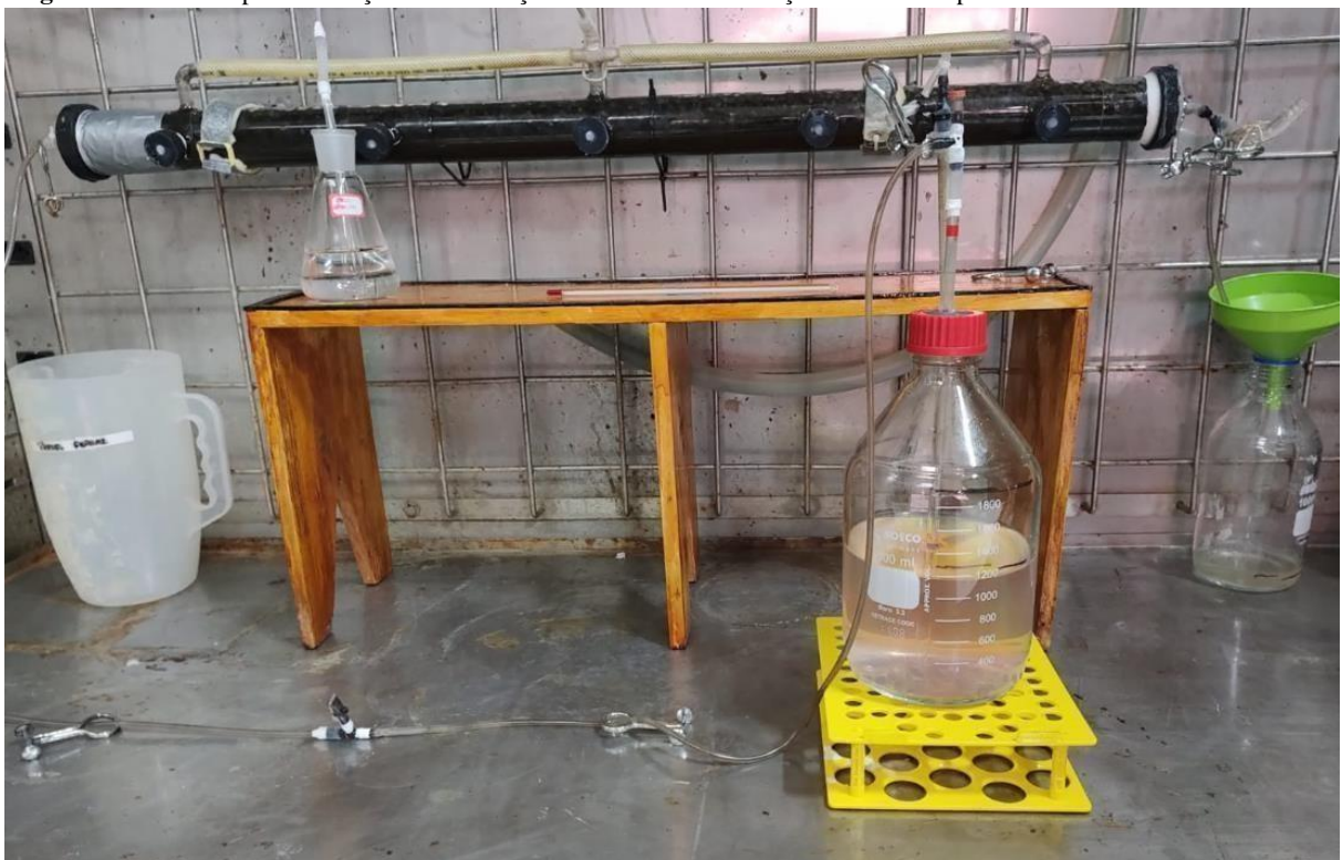
Figura 11: RAHLF após inoculação com formação de biofilme na coloração escura no suporte fixo.
