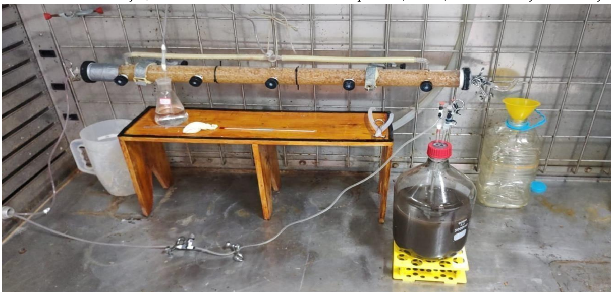
Figura 10 - Sistema completo do Reator RAHLF em escala de bancada montado dentro da câmara de climatização, com o frasco-reator do sedimento enriquecido (inóculo) antes de começar a inoculação
