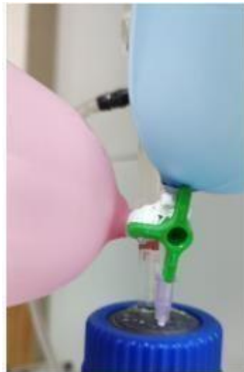
Figura 9 - Sistema de compensação da pressão e manutenção da atmosfera anaeróbia
