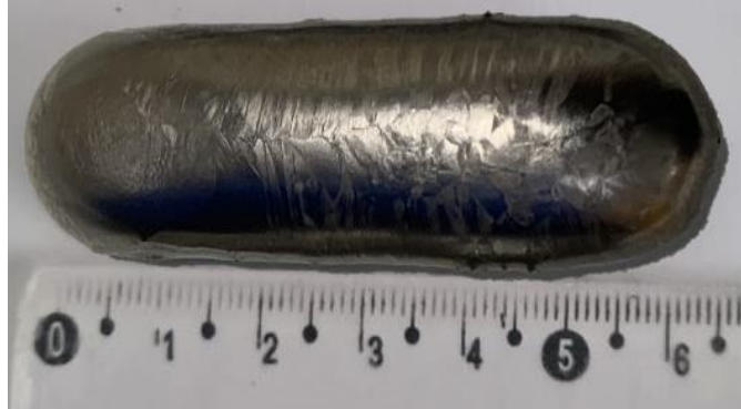
Figura 10 - Lingote da liga 97Ti-2Si-1B de 40 g produzido por fusão a arco
