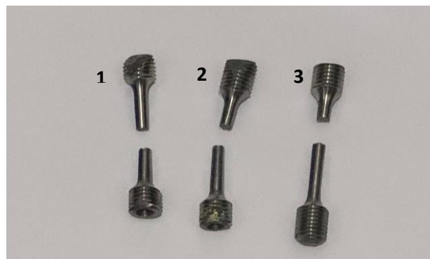
Figura 13 - Corpos de prova rompidos após ensaio de tração
