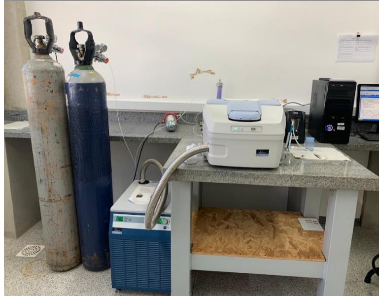
Figura 15 - Imagem do equipamento DSC 8000 e Intracooler 2, do departamento de Engenharia de materiais da USP São Carlos
