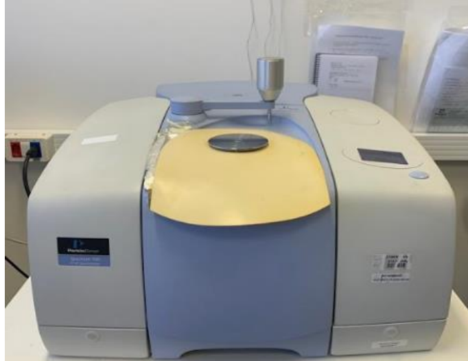
Figura 10 - Imagem do equipamento Spectrum 100 para o ensaio de FTIR, localizado no departamento de Engenharia de materiais da USP São Carlos
