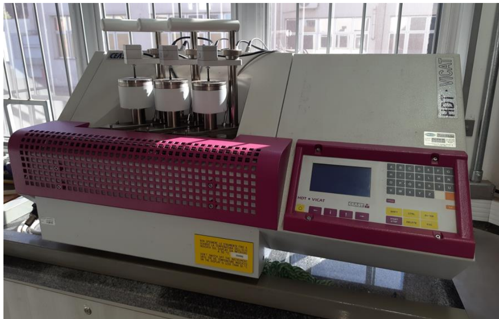
Figura 19 - Imagem do equipamento HDT 3 VICAT para o ensaio de HDT e VICAT, localizado no departamento de Engenharia de materiais da USP São Carlos
