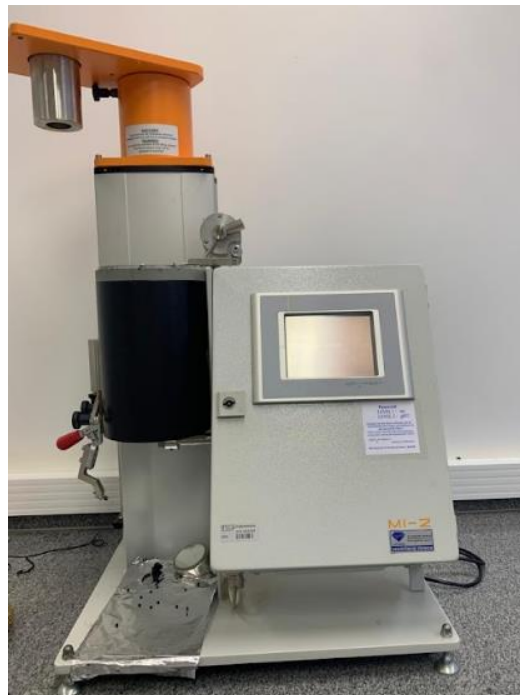
Figura 12 - Imagem do Plastômetro MI-2, localizada no departamento de Engenharia de materiais da USP São Carlos
