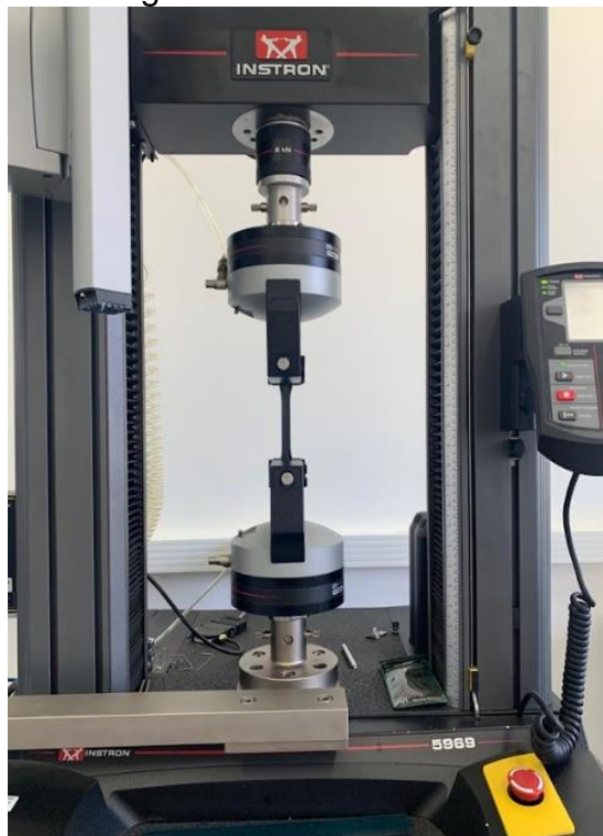
Figura 20 - Imagem do equipamento de ensaio universal Instron 5969, localizado no departamento de Engenharia de materiais da USP São Carlos
