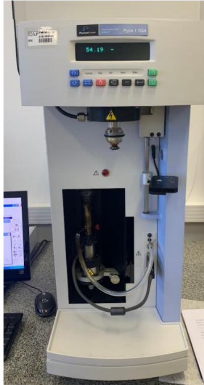
Figura 17 - Imagem do equipamento Pyris 1 TGA, do departamento de Engenharia de materiais da USP São Carlos
