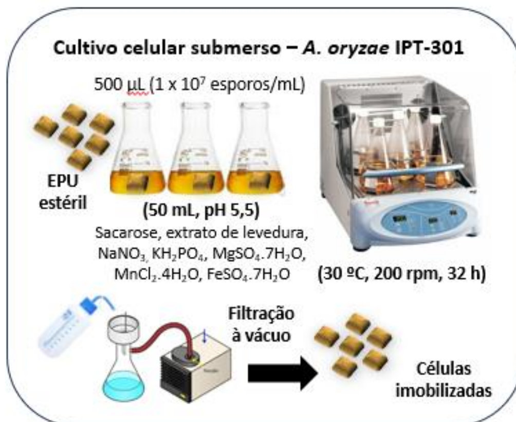
Figura 4 – Primeira etapa da metodologia experimental – obtenção do biocatalisador heterogêneo por cultivo celular submerso
