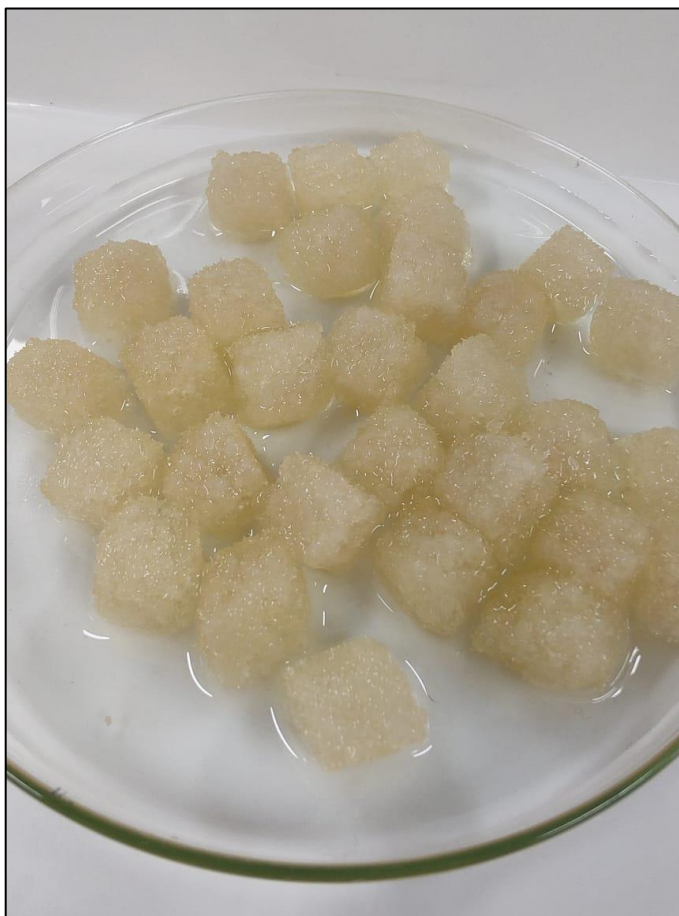
Figura 7 – Cubos de EPU contendo células de A. oryzae IPT-301 imobilizadas durante o cultivo celular
