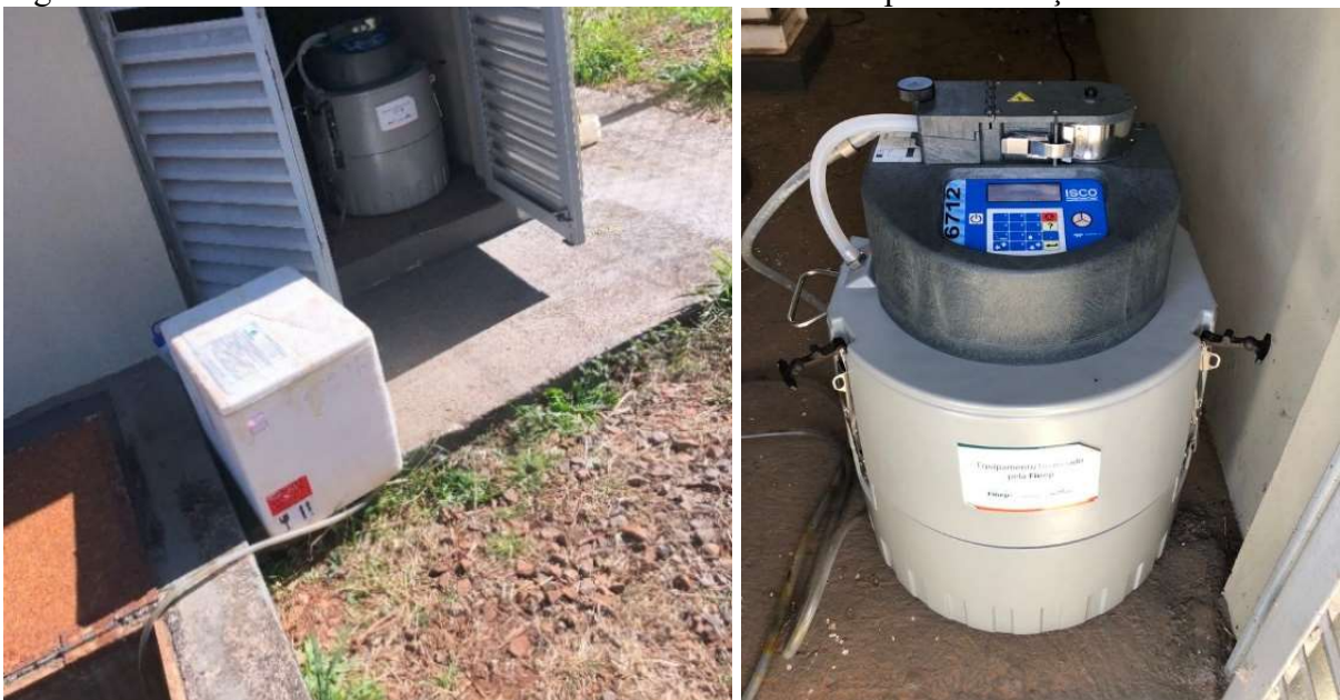
Figura 6 – Amostrador automático ISCO série 6712 utilizado para realização das coletas
