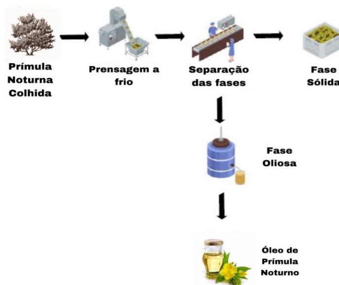
Figura 2 - Fluxograma da Produção de Óleo de Prímula
