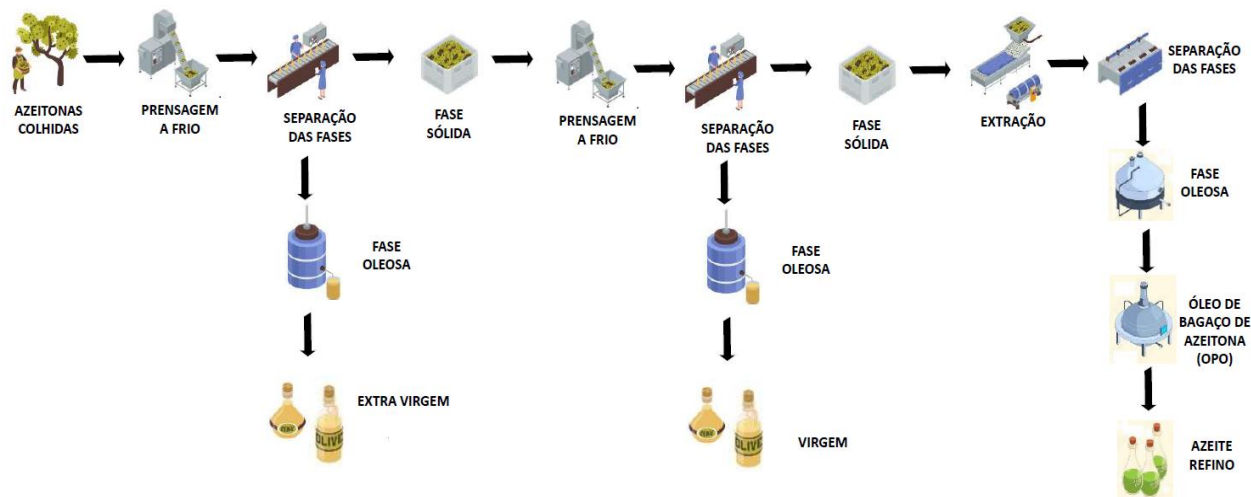
Figura 1 - Fluxograma da Produção de Óleo de Oliva
