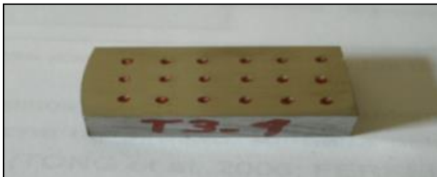
Figura 15 - Corpo de prova para medição de dureza do pino anódico sem tratamento superficial pós-regime de trabalho.
