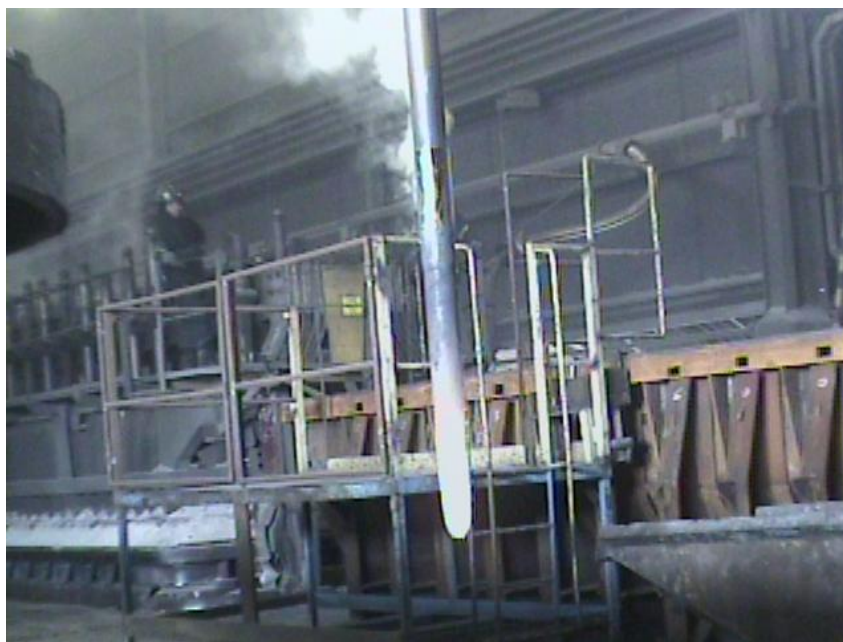
Figura 17 - Pino anódico imediatamente após sacagem, para ser submetido à termografia.
