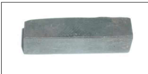
Figura 13 - Corpo de prova para caracterização da nitretação.
