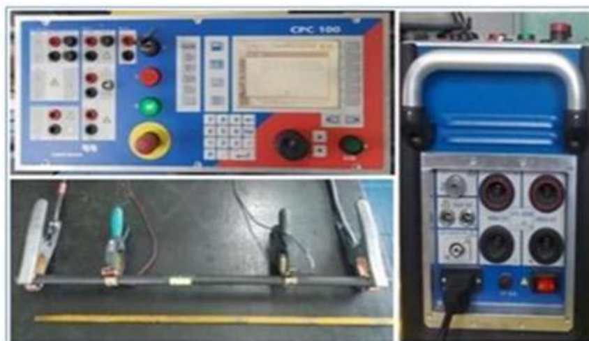
Figura 16 - Equipamento utilizado para medição de resistência elétrica dos corpos de prova.
