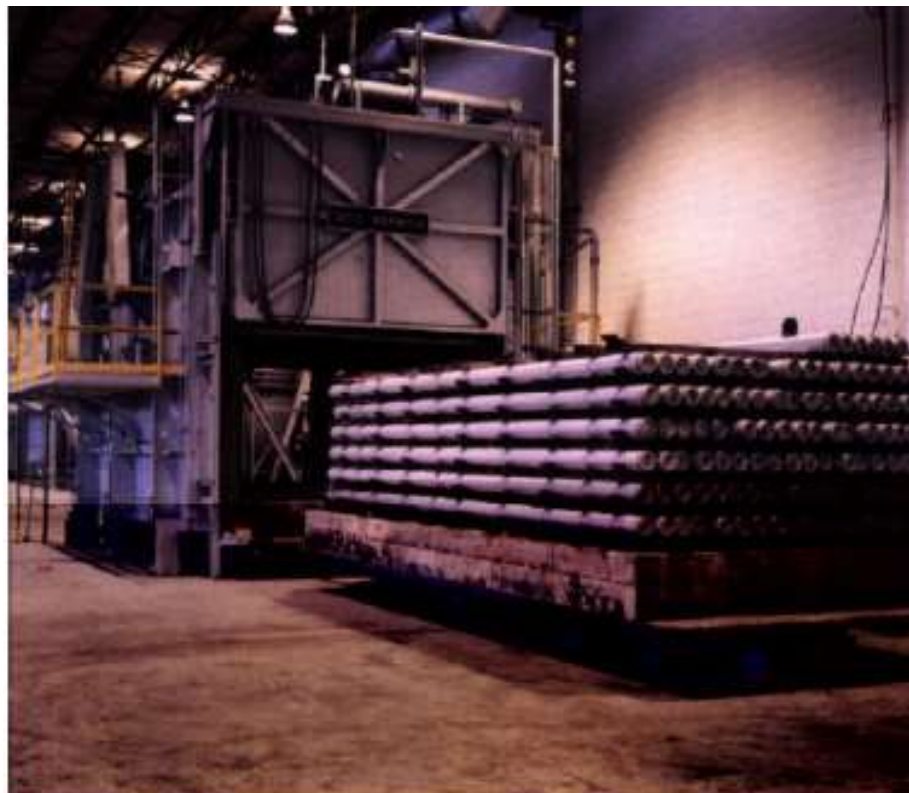
Figura 11 - Distribuição de tarugos em um forno batelada de homogeneização
