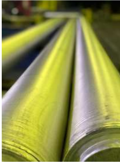
Figura 5 - Solidificação da liga de alumínio da série 6000, na forma de tarugo
