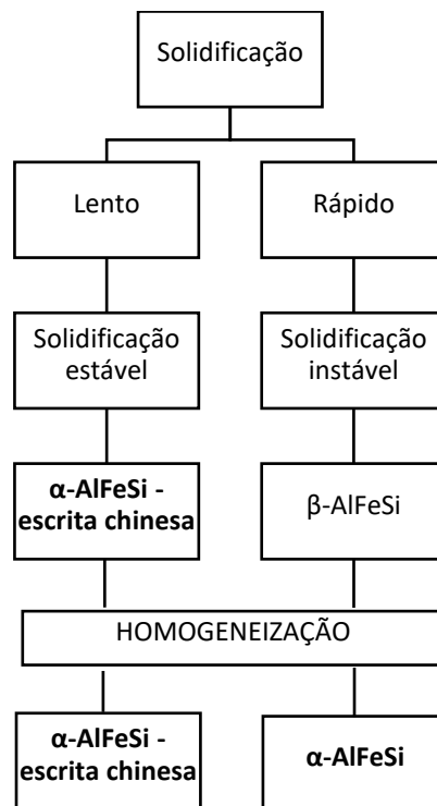
Figura 18 - Esquema de potencial de formação de fases intermetálicas em função da forma da solidificação
