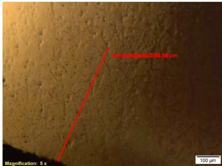
Figura 39 - Micrografia obtida por microscopia ótica da segregação inversa da liga 6063 sem tratamento térmico
