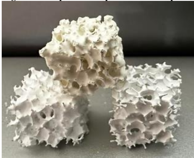
Figura 1 - Corpos obtidos por técnica de réplica
