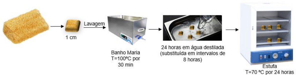
Figura 5 – Pré-tratamento da esponja vegetal para uso como material de suporte
