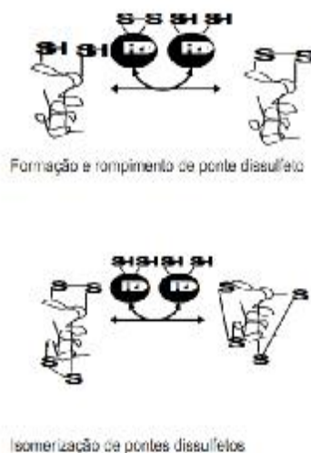
Figura 6. Atividade catalítica na formação e rompimento e na isomerização de pontes dissulfeto intra-moleculares catalisadas por PDI. Adaptado de Wilkinson 2004.
