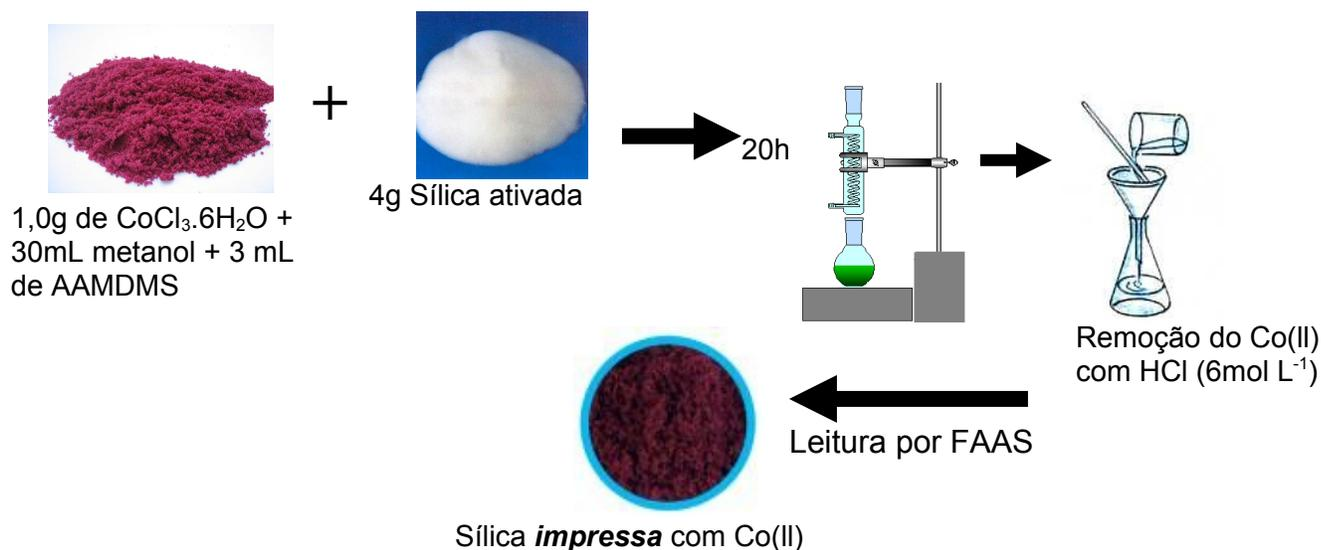
**Figura 9** - Representação esquemática das etapas associadas à formação do complexo cobalto-AAMDMS e modificação da sílica gel.
