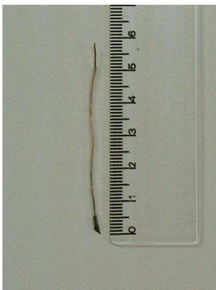
Figura 12 : biossensor preparado com tubo de polietileno 0,4 mm d. i.
