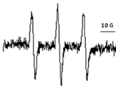
Figura 15. Espectro de EPR característico do nitróxido Ac-Tempo (100 \mu M).
