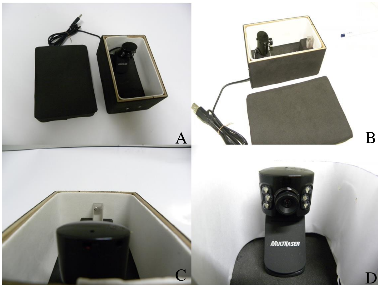
Figura 15: A câmara fotográfica portátil desenvolvida empregando-se uma web cam Fonte: Do autor
