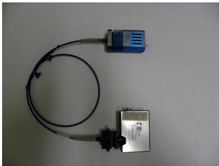
Figura 13: Detector empregado e seus acessórios: Espectrofotômetro USB 4000 (UV-Visível), fonte de luz, fibra óptica e cubeta de quartzo.
