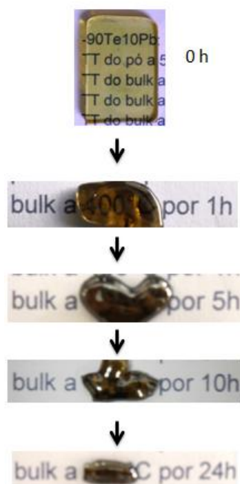
FIGURA 36 - Aspecto visual da amostra 90Te10Pb com diferentes tratamentos térmicos.
