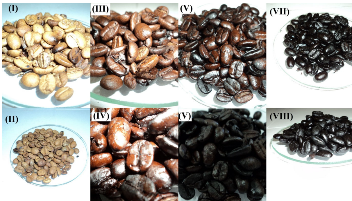
Figura 16. Amostras obtidas após o processo de torra. Tempos de torra de (I) 1 minuto; (II) 2 minutos; (III) 3 minutos; (IV) 4 minutos; (V) 6 minutos; (VI) 8 minutos; (VII) 10 minutos e (VIII) 12 minutos.
