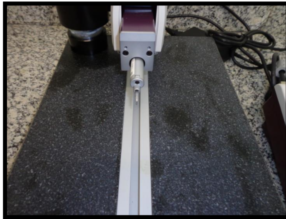
Figura 9 – Ponta apalpadora esférica de diamante Mitutoyo SJ-410
