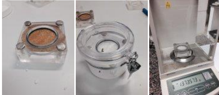
Figura 8 - Célula de permeação - teste de permeabilidade ao vapor d'água.
