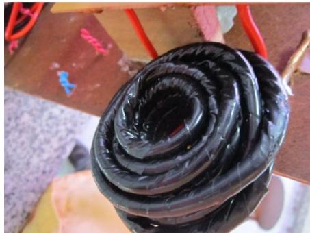
Figura 34: Indutor do circuito oscilador.
