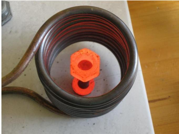
Figura13 – Metal aquecido por campo magnético alternado.
